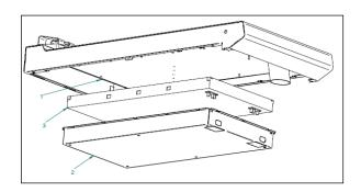
Для замены ТЭНов, сперва надо снять ручки управления, выдвижной ящик для сбора жира и панель управления, затем ослабить болты (1), крепящие основание ТЭНов (2); далее
