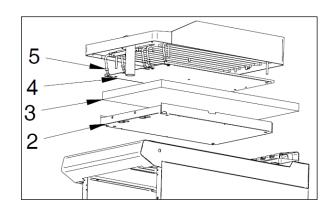
Для замены ТЭНов, сперва надо снять ручки управления, выдвижной ящик для сбора жира и панель управления, затем снять гайки (1), крепящие конфорку к поверхности; приподнять конфорку и перевернуть её. Затем отвернуть крепёжные винты крышки, снять крышку (2), изоляцию (3), защитный кожух (4) и отсоединить ТЭН (5), подлежащий замене, затем извлечь его. После замены неисправной детали следует поставить на место все части, внимательно действуя в обратном порядке по отношению к описанному выше.
