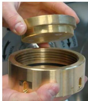
Проверить, что после того как завинтили фильеру посредством специального зажимного кольца, вал, который передаёт движение шнеку, хорошо введён в гнездо, расположенное на том же шнеке
