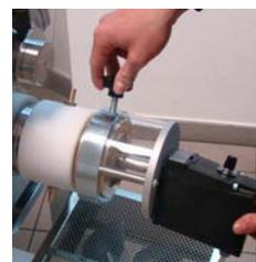
Поместите вентилятор на тележке и закрепите его посредством обеспеченных наборов винтов и болтов
