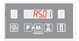
Возможные сообщения о неисправностях выводятся на дисплее печи **DeckTop™** (если она автономная) или на дисплее печи **BAKERTOP MIND. Maps™**, к которому подсоединена печь **DeckTop™**(если она контролируемая).
