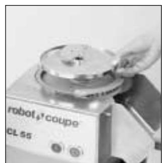
Установите затем соответствующий диск ломтиki и убедитесь, что он установлен правильно, поворачивая его в направлении часовой стрелки.
